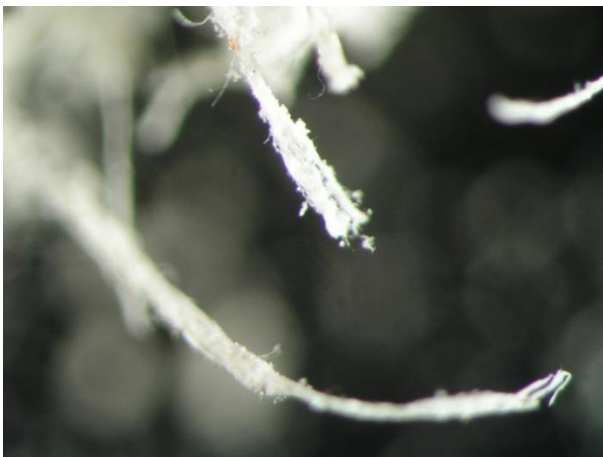
Particolare di fibra di amianto (63x)
